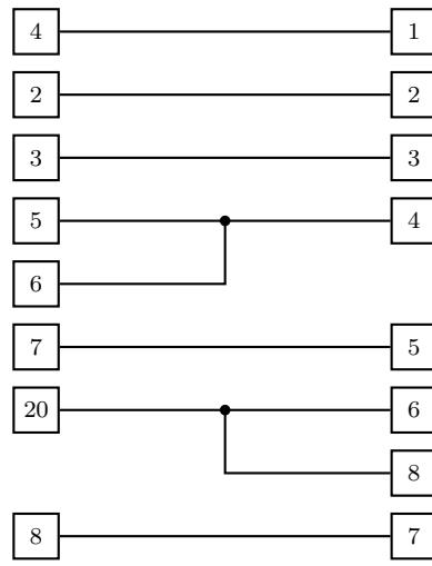
RS232-Kabel für die Verbindung von Plotter
