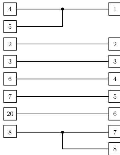
RS232-Kabel für die Verbindung des HP-
